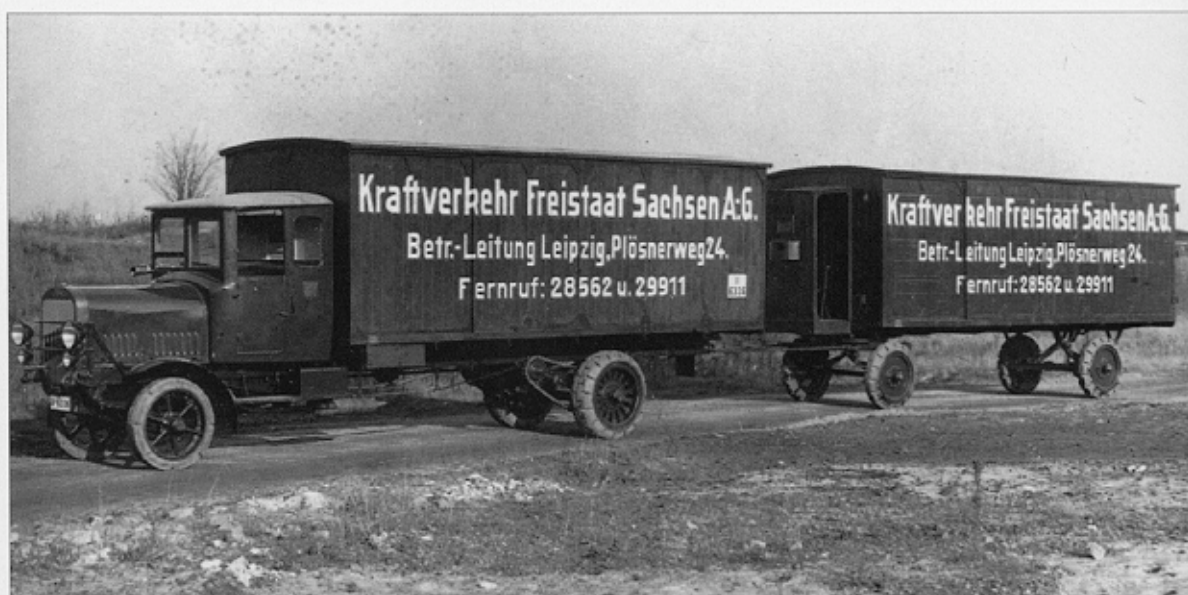
Ein Lkw auf dem technischen Stand zu Beginn der zwanziger Jahre: Kettenantrieb, Vollgummibereifung und handgebremster Anhänger. Die „Kraftverkehr Freistaat Sachsen AG“ war eine von 17 Gesellschaften dieser Art und die einzige, die wirtschaftlich arbeitete. Freie Klein- und Kleinstfuhrunternehmer drängten zunehmend auf den Markt Foto: Slg. Weinreich
