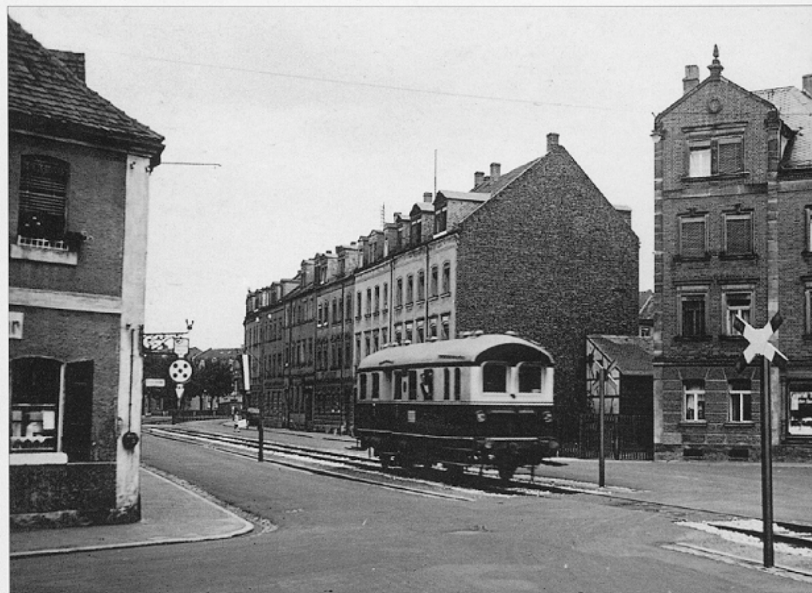
Ein Werdauer Benzoltriebwagen in den noch autoleeren Straßen von Erlangen am 12. Mai 1933. Vier Stück (VT 705 – 708) umfaßte diese 1927 gebaute Serie nur, es wurde noch viel experimentiert in jenen Jahren Foto: Nowak
