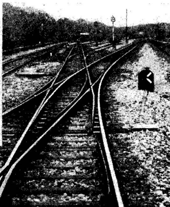
Signal Wn 6: Im Bogen von rechts nach rechts
