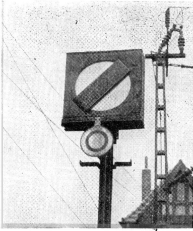
Bild 196 Kreisscheibe an einem Gleissperrsignal, das in Grundstellung das Signal Gsp 1 zeigt
